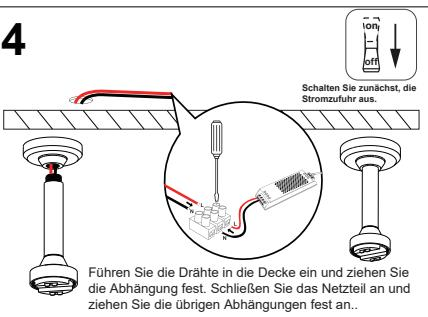
Führen Sie die Drähte in die Decke ein und ziehen Sie die Abhängung fest. Schließen Sie das Netzteil an und ziehen Sie die übrigen Abhängungen fest an..
