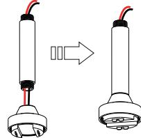
Bei Abhängungen die zugleich als Kabeldurchführung dienen, führen Sie die Drähte durch. Danach werden die abgebildeten Teile fest miteinander verschraubt.
