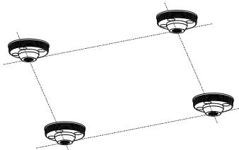
Positionierung: Wählen Sie die Auslassposition und bohren Sie die Löcher.
