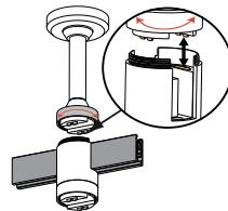
Die Schiene ausrichten und auf der Basis platzieren.
